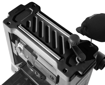
Fig. 13 – Removiendo la tapa superior
